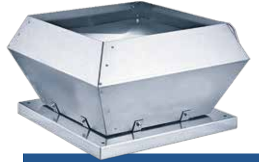
Radyal pervaneli, dikey atışlı, direkt akuple motorlu çatı tipi fan
