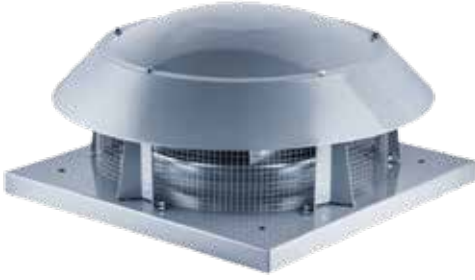
Radyal pervaneli, yatay atışlı, kubbe şapkali, dıştan rotorlu, direkt akuple motorlu çatı tipi fan
